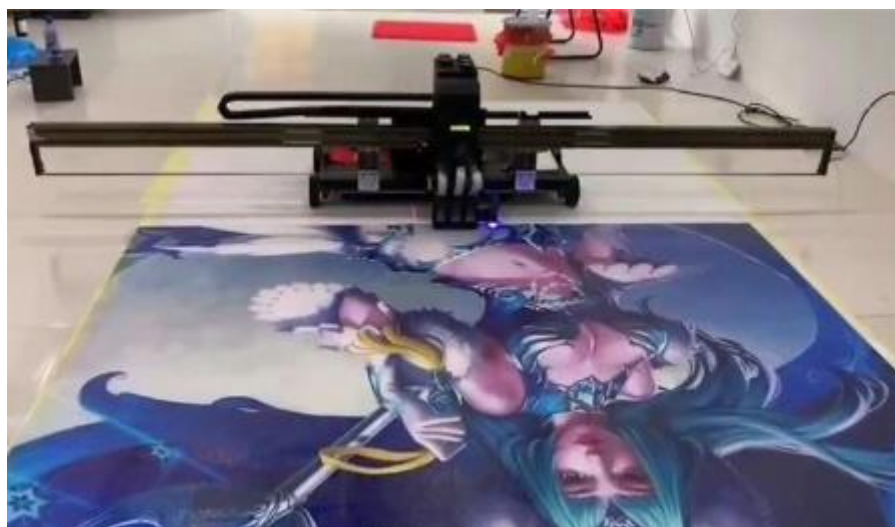
Rys. 4. Drukarka podłogowa UV TFP1000 o wysokiej rozdzielczości i jeden z efektów jej pracy Źródło: Suzhou Tanyu Technology Co., Ltd., Drukarka podłogowa UV TFP1000 o wysokiej rozdzielczości: https://pl.rareprinter.com/floor-printer/high-resolution-uv-floor-printer-machine.html [dostęp: 14.01.2024].
